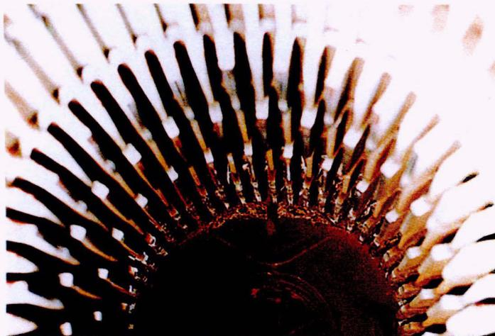
Feuerungsraum eines Heizkessels nach dem Einsatz von additivem Heizöl-EL.
